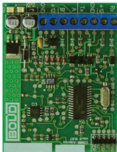
Модуль управления приборами Ademco 58xx по интерфейсу RS-485
