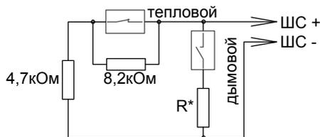
Включение нормально-разомкнутых ("дымовых") и нормально-замкнутых ("тепловых") пожарных извещателей в ШС типа 2 ("Пожарный комбинированный")
