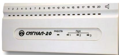
Предназначен для использования в автономном режиме или в составе ИСО «Орион» для контроля различных типов охранных и пожарных неадресных извещателей, контакторов и сигнализаторов с нормально-замкнутыми или нормально-разомкнутыми контактами и релейного управления внешними исполнительными устройствами. Для работы в автономном режиме имеет клавишное управление.
