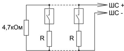
Включение нормально-разомкнутых ("дымовых") пожарных извещателей в ШС типа 1 ("Пожарный дымовой с распознаванием двойной срабатки"). R = 1,5 кОм±5% для ДИП-3СУ, ДИП-У (напряжение на сработавшем извещателе от 7,5 до 8,5 В)
