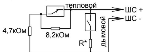
$R^* = 0$  для ДИП-3М, ДИП-3СУ, ДИП-У, 2100, 2151Е (напряжение на сработавшем извещателе  $> 4В$ )
