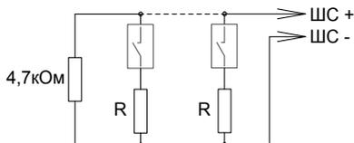
Включение нормально-разомкнутых ("дымовых") пожарных извещателей в ШС типа 1 ("Пожарный дымовой с распознаванием двойной срабатки").
