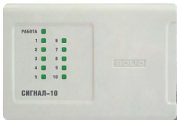
*«Сигнал-10» предназначен для совместного использования с сетевым контроллером (пультом «С2000М» либо компьютером с АРМ «Орион») в качестве совмещённого приёмно-контрольного прибора и прибора управления в составе комплексов технических средств: охранной и тревожной сигнализации, пожарной сигнализации и автоматики, систем оповещения и управления эвакуацией 1 и 2 типов*
