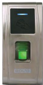
*Предназначен для совместной работы с АРМ «Орион Про» и организации системы контроля и управления доступом (СКУД) по биометрическим идентификаторам - отпечаткам пальцев.*
