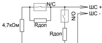
Включение нормально-разомкнутых и нормально-замкнутых датчиков в ШС типа 12 ("Пожарный программируемый")
