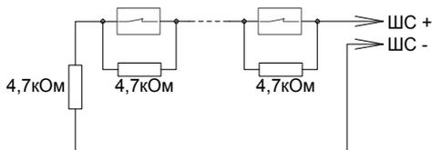
Включение нормально-замкнутых ("тепловых") пожарных извещателей в ШС типа 3 ("Пожарный тепловой с распознаванием двойной срабатки")
