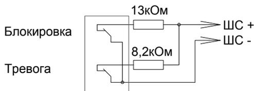
Включение охранных извещателей с блокировочными контактами в ШС типа 5 ("Охранный с контролем блокировки")
