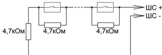
Включение нормально-замкнутых ("тепловых") пожарных извещателей в ШС типа 3 ("Пожарный тепловой с распознаванием двойной сработки")
