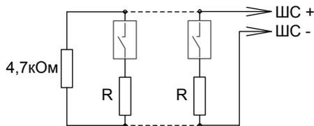
Включение нормально-разомкнутых ("дымовых") пожарных извещателей в ШС типа 1 ("Пожарный дымовой с распознаванием двойной сработки"). R = 1,5 кОм±5% для ДИП-ЗСУ, ДИП-У (напряжение на сработавшем извещателе от 7,5 до 8,5 В)
