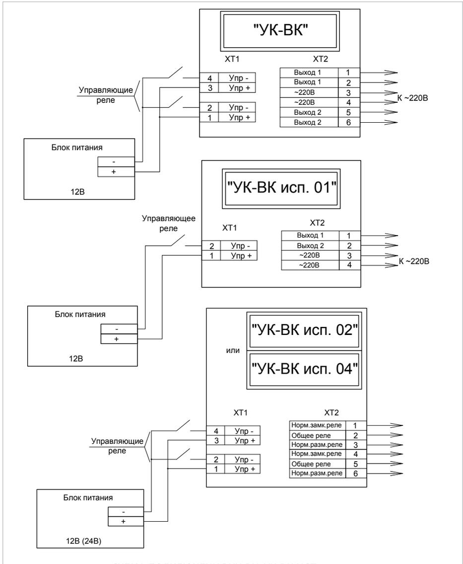
СХЕМА ПОДКЛЮЧЕНИЯ УК-ВК, УК-ВК ИСП. 01, 02, 04
